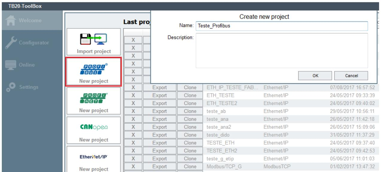
Após criado um Projeto novo, você de verá configurar os módulos de I/O que irão compor o barramento da Cabeça Remota.
