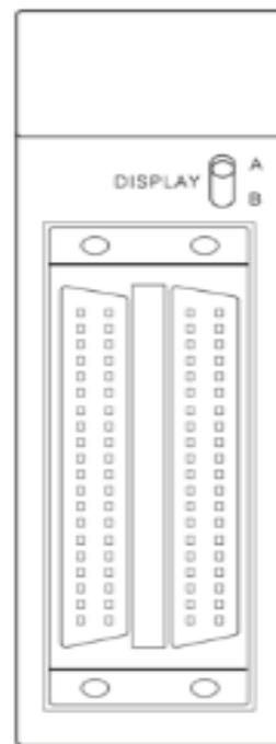
**Observação: A conexão física das Entradas Digitais é feita através de cabo especial conectado a base borneira (SL40).**
